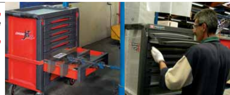
As gavetas são testadas para 50000 aberturas/fechos ao longo de 10 anos de utilização.
